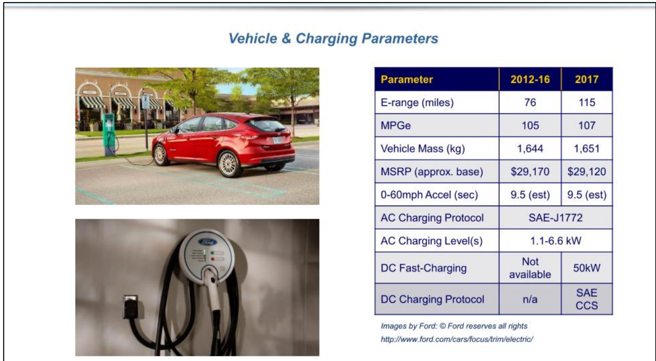
Figura 43. Veicolo e parametri di ricarica (Fonte: Total Battery Consulting) [22]
