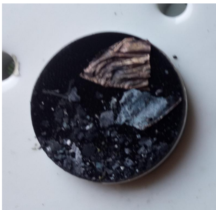
Figura 26 Residui batteria incendiata, campione 3.
