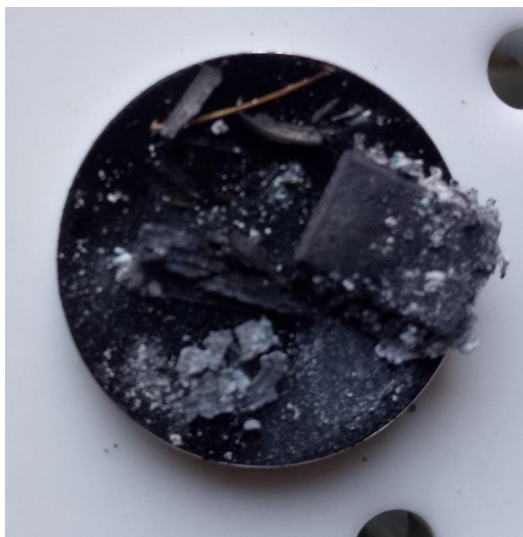
Figura 21. Residui batteria incendiata, campione 2.
