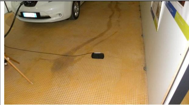
**Figura 51 – Misura di fondo del campo magnetico statico**
