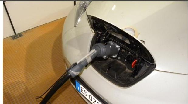
**Figura 54 – Punto di misura sul connettore CHAdeMO (manipolo) a 3.5 m dall'uscita del pannello**
