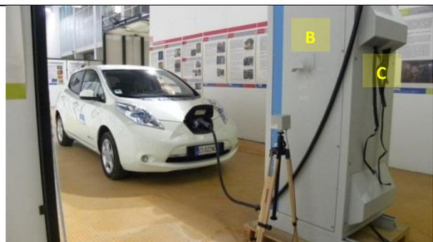
**Figura 7 – Vista del setup di misura, lati B e C, durante una ricarica**
