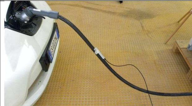
**Figura 53 – Punto di misura sul cavo DC a 3 m dall'uscita dal pannello**
