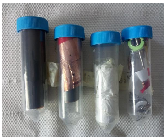
Figura 6 Contenitori per la conservazione dei materiali costituenti una cella Panasonic NCR 18650: (da sinistra) catodo, anodo, film polimerici, parti metalliche e plastiche esterne.
