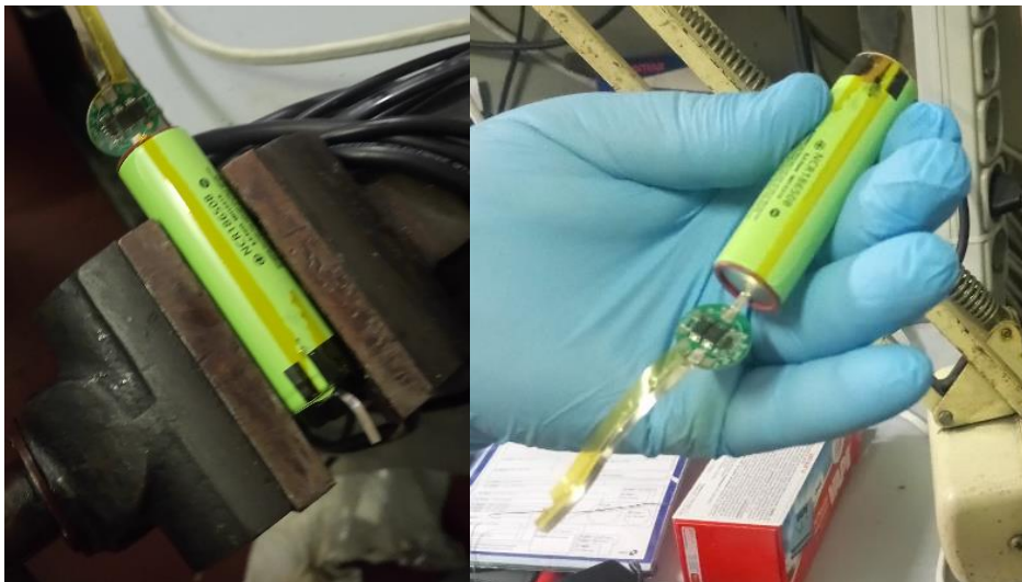
Figura 4 Apertura della cella Panasonic NCR 18650B (PR).
