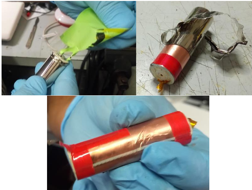
Figura 3 Sequenza di apertura di una cella Panasonic NCR 18650.
