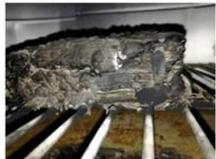
Figura 12. Esposizione a fiamma del modulo Thundersky dopo cortocircuito [4] (v. figura 11)
