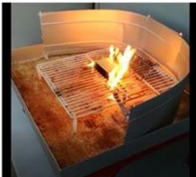
Figura 12. Esposizione a fiamma del modulo Thundersky dopo cortocircuito [4] (v. figura 11)
