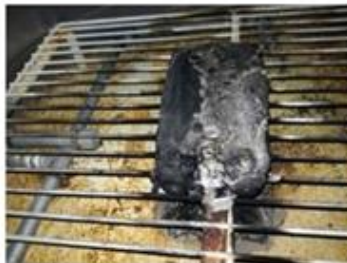
Figura 12. Esposizione a fiamma del modulo Thundersky dopo cortocircuito [4] (v. figura 11)
