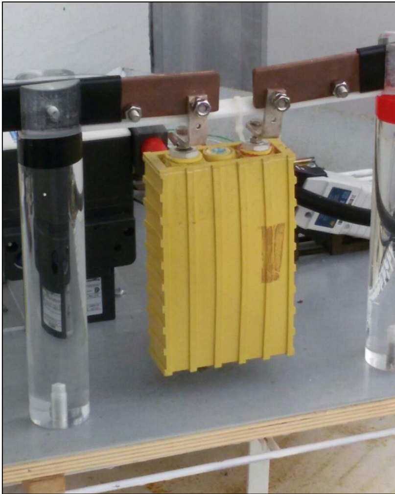
Figura 11. Prova di cortocircuito su Modulo Thundersky
