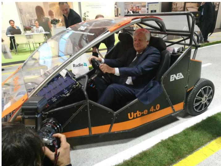
Il veicolo poneva in risalto l'uso di una Fuel Cell per l'ibridizzazione della propulsione elettrica affiancata da Supercapacitori senza ausilio di un accumulo a batteria (nella foto il ministro dell'Ambiente a bordo del veicolo).
