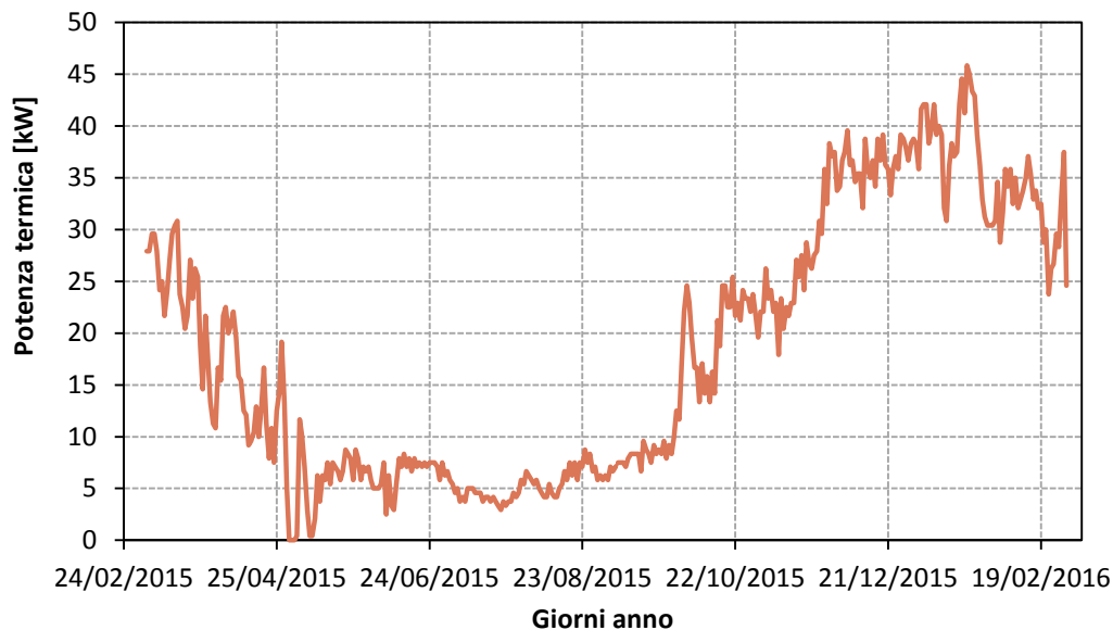
Figura 4: Profilo di carico termico annuale dell'utenza condominiale
