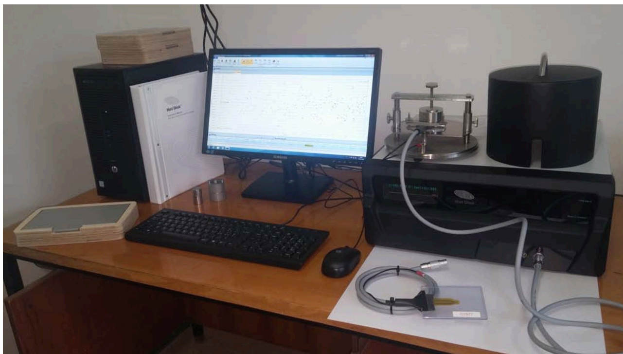
Figura 35. Sistema HotDisk TPS500S installato presso i laboratori ENEA. Setup sperimentale per le misure di conducibilità termica
