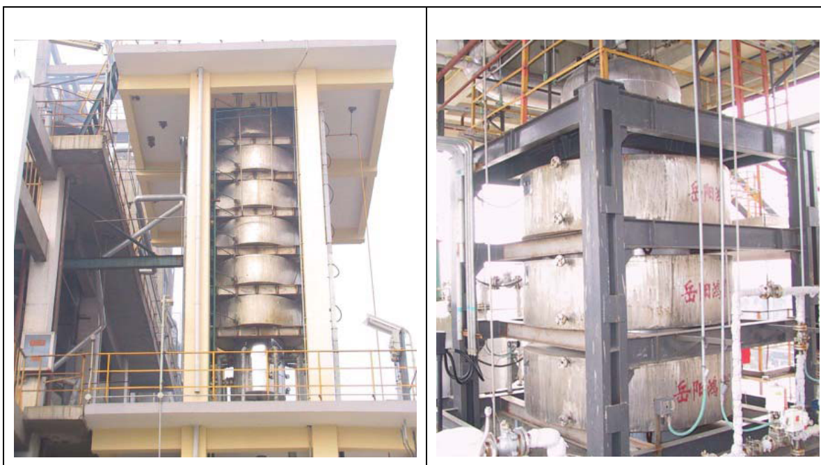
Figura 3.3.4. Due reattori industriali magneticamente stabilizzati per la purificazione ( hydrorefining ) del caprolattame: 200 kt/anno (a sinistra) e 300kt/anno (a destra).
