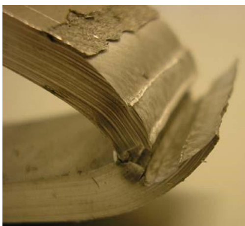
Figura 18 Provino di piega 00-P21 – rottura per sfaldamento/scollatura
