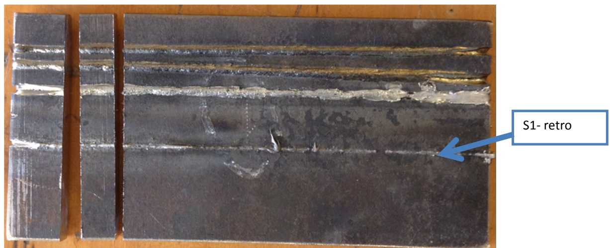
Fig. 21- Lato B. la freccia indica il retro della saldatura (S1) [MSOffice3]
