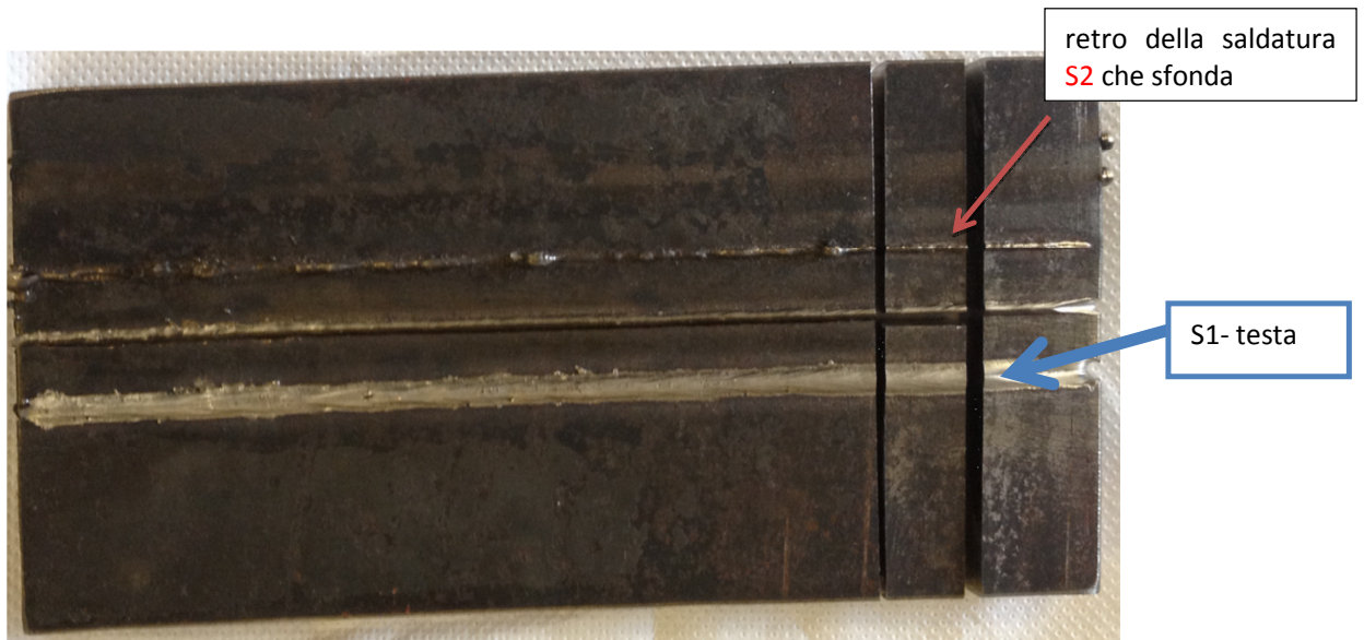
Fig. 20: Lato A. la freccia blu indica la testa del cordone (S1)
