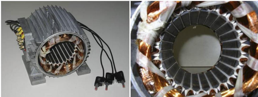
Figura 4: immagine di uno statore (Fonte: la rete)
