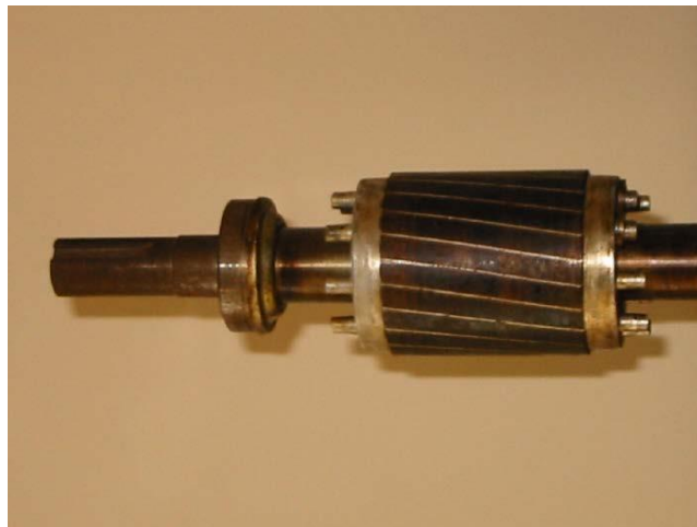
Figura 6: Figura 5: immagine di un rotore a gabbia (Fonte: la rete)
