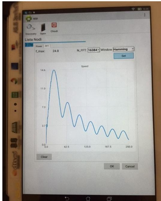
Figura 71 Risultato di un'analisi spettrale mediante la App finalizzato alla misura della velocità di rotazione.
