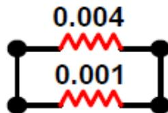
Figura 9 Schema semplificato che illustra il parallelo di due resistori shunt per ottenere un valore di shunt desiderato.
