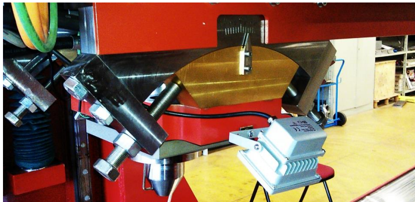
Fig. 4 – Sistema di regolazione dell'angolo di tilt
