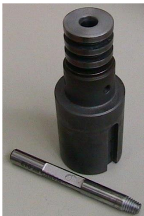
Fig. 6 – Utensile FSW scomponibile
