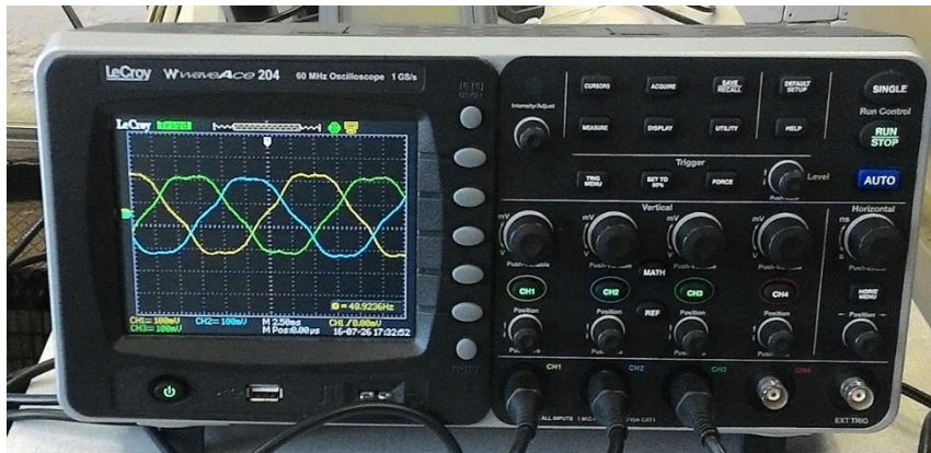
Fig. 13 - Oscilloscopio LeCroy – modello WaveAce 204
