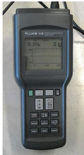
Fig. 12 - Wattmetro elettronico digitale Fluke – modello 418
