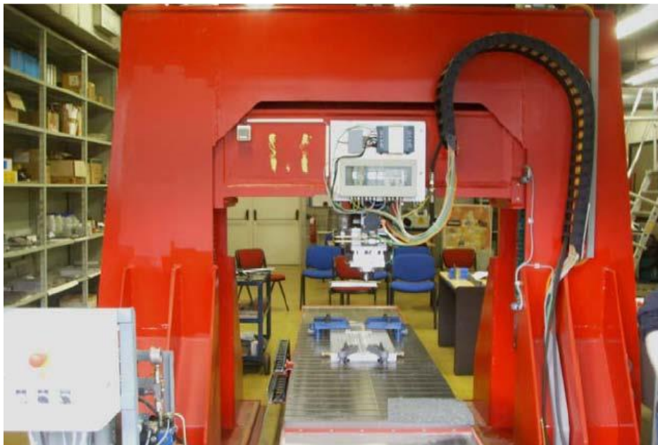
Fig. 1 – Macchina FSW-Gantry (H.Loitz-Robotik)
