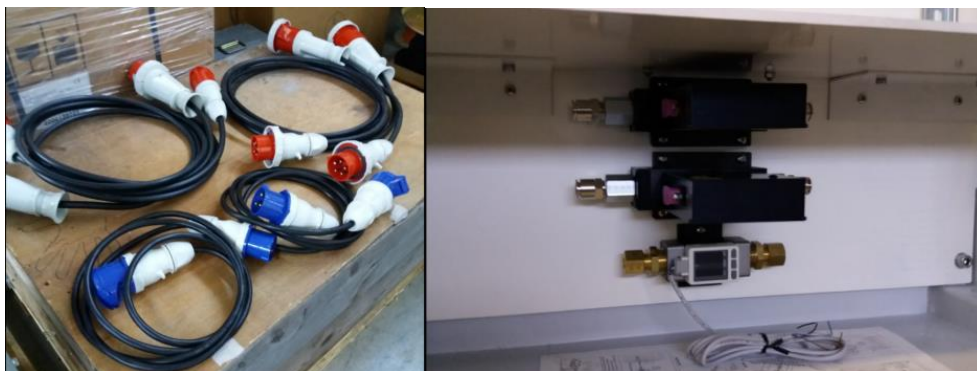
Figura 32: Cavi di connessione (SX), Sistemi di misura di flusso per Ar, He, Aria/N2 (DX)
