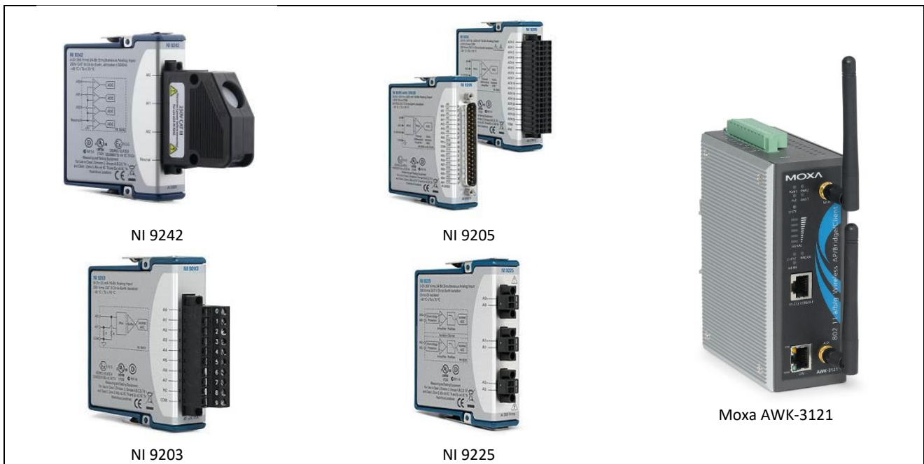
Figura 29: schede acquisizione segnali e modulo WiFi industriale
