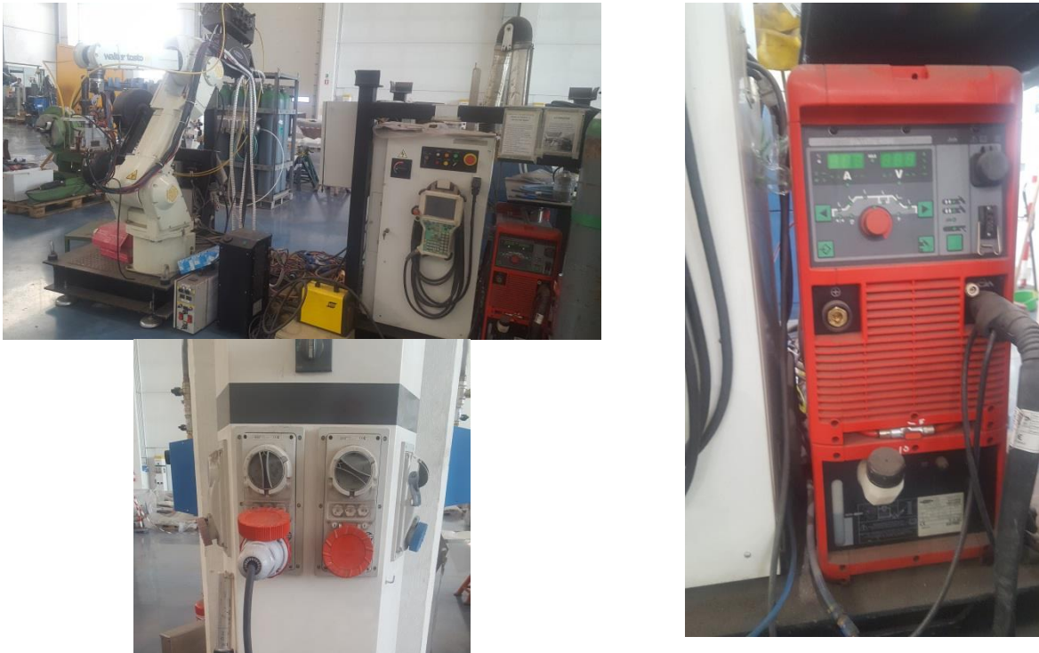
Figura 25: Sistema Robotizzato di saldatura GTAW della Walter Tosto modello Fronius alimentato su presa 380 V 63 A
