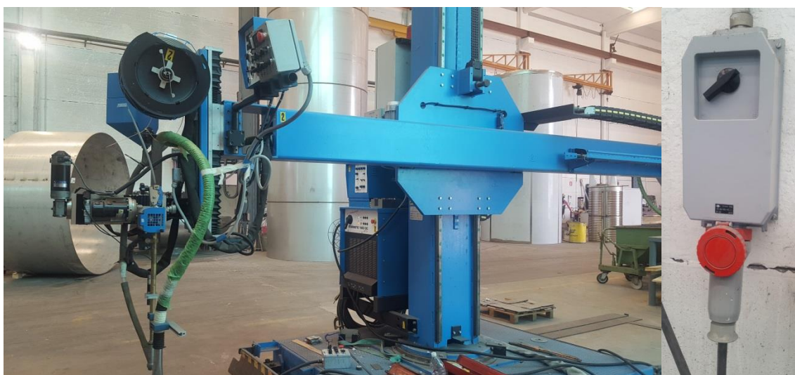
Figura 26: Sistema Robotizzato di saldatura SAW della Walter Tosto modello SAF Starmatic 1003 DC alimentato su presa 380 V 125 A
