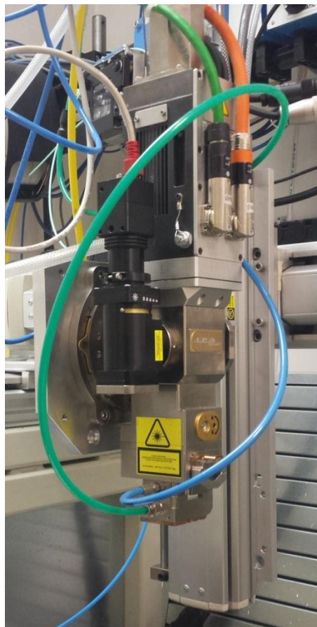
Figura 12: Set UP misure efficienza laser (SX); Sistema di variazione fuoco asse Z (DX)
