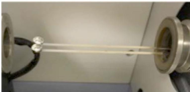
Figura 2.3. a) Pyris Diamond TG/DTA Perkin Elmer: unità di base (sinistra), unità di misura e fornace (destra); b) Schematizzazione di principio della bilancia termogravimetrica, configurazione di misura; c) le aste e i crogioli nella configurazione aperta fuoriescono dal nodo di miscelazione posto a monte della fornace.
