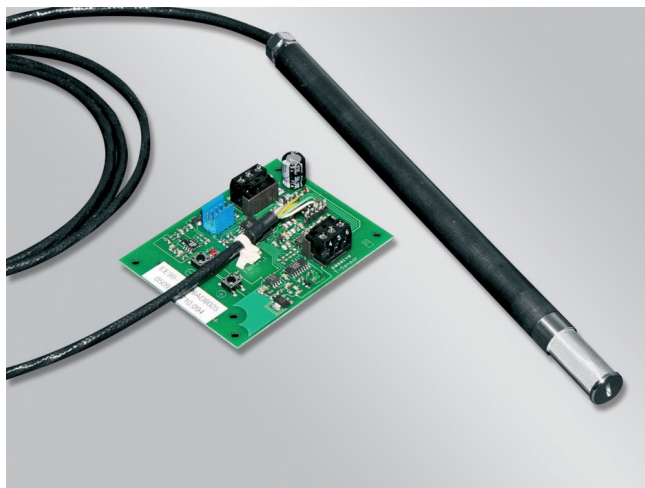
Figura 23. Sensore umidità e temperatura (thermoigrometro).
