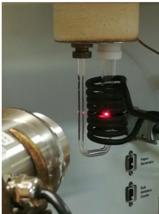
Figura 2. Immagine dell'induttore (diametro= 2.5cm altezza=4.5cm) che circonda il ramo del reattore in quarzo all'interno del quale è inserito il catalizzatore. Un pirometro permette una stima della temperatura raggiunta dal catalizzatore.
