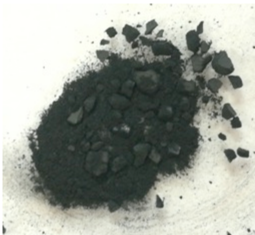
Figura 14. Immagine del catalizzatore composito “Reformax/Co” dopo il suo utilizzo nelle condizioni di processo.
