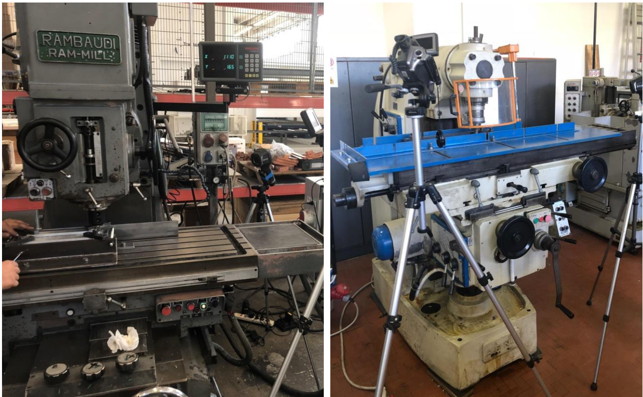
Figura 74: impianti FSW, RGM Metalworks (sx) e Dip. Ing. Meccanica Univ. Genova
