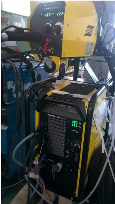
Figura 17: gen. MIG Esab Warrior 400i e parametri di prova
