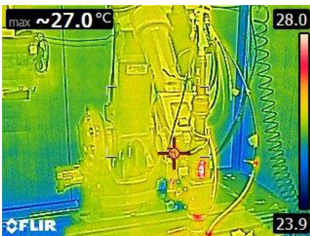
Figura 36: Monitoraggio degli armadi elettrici di potenza del laser TRUMPF prima dell'emissione
