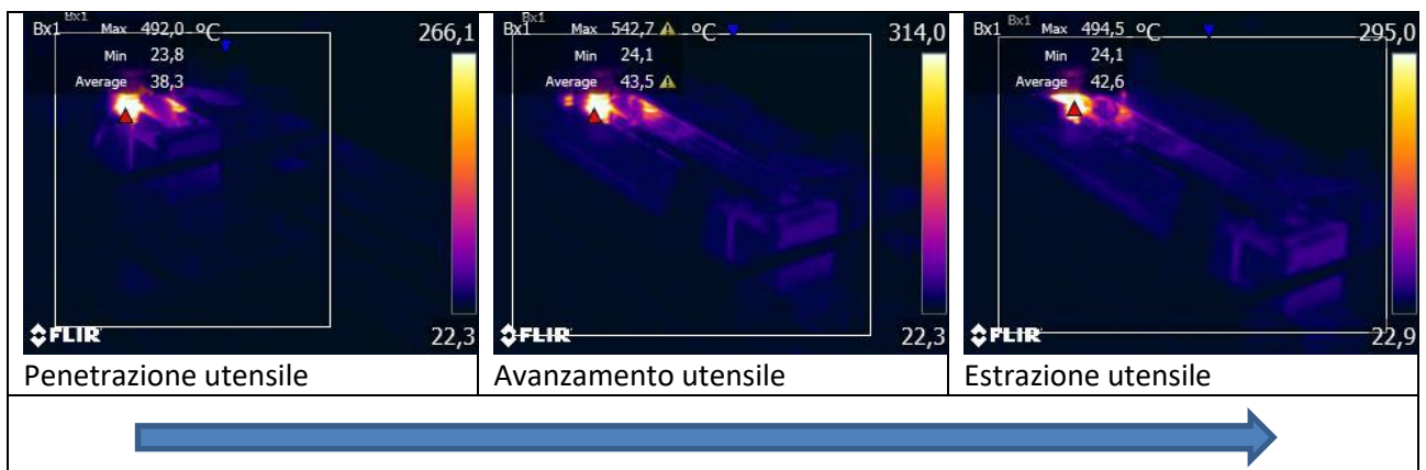
Figura 80: Analisi termografiche durante il processo di sldatura FSW (Acquisizione presso RGM)
