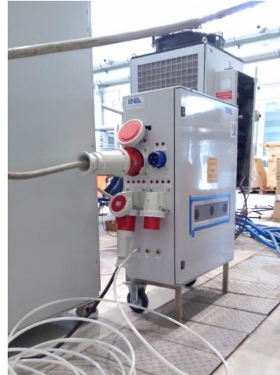
Figura 27: UniSalerno, imp. Elios (SX), collegamenti per misura assorbim. Laser e chiller e flusso aria (DX).
