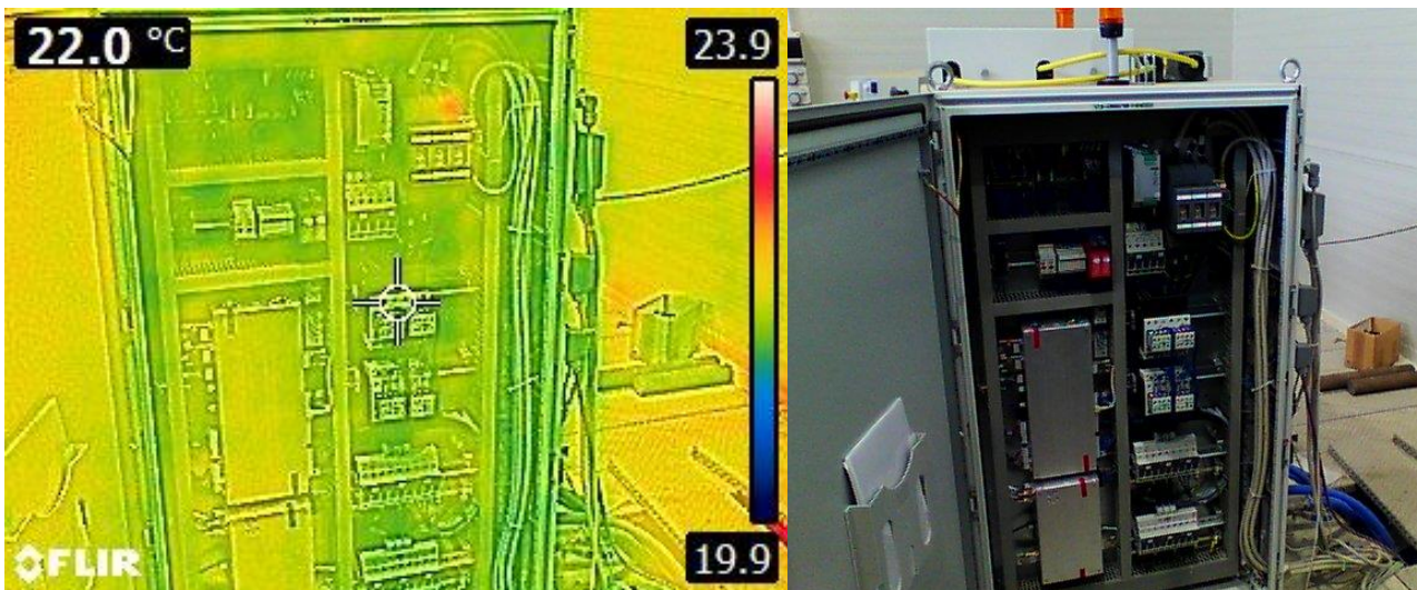
Figura 39: Monitoraggio degli armadi elettrici di potenza del Sistema di movimentazione TLW 2.1
