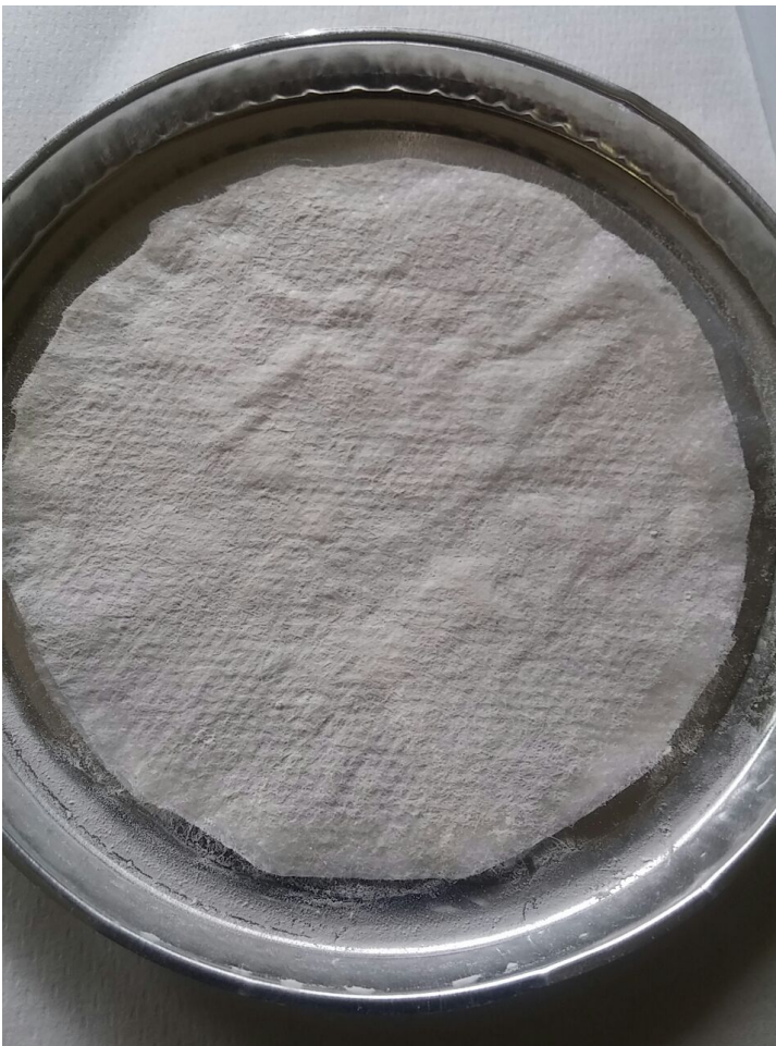
Figura 2.3. Sistema di confinamento del MOF tra due strati di tessuto non tessuto a base polipropilene. A destra è mostrato il substrato NWPP tal quale su cui il MOF è stato fatto aderire mediante il collante acrilico spray 3M ReMount.
