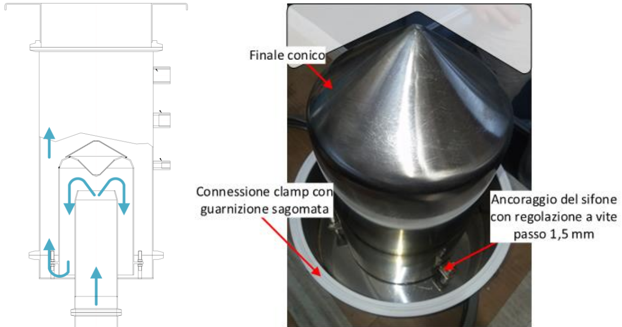
Figura 3.3 Disegno esecutivo e foto del letto di materiale adsorbente in cui si mette in evidenza la geometria interna ed il sistema di regolazione del sifone.
