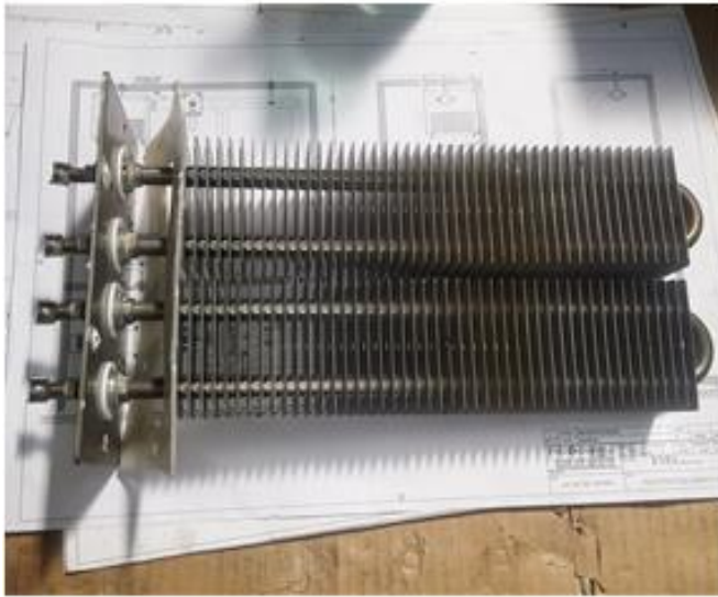
Figura 3.6 Riscaldatori elettrici montati su flangia di inserzione trasversale nel plenum
