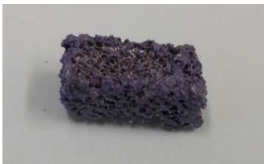
Figura 3: Immagine del supporto di allumina macroporosa impregnata con una soluzione di acetato di Ni e di Co 6:4 (campione ENEA 14)
