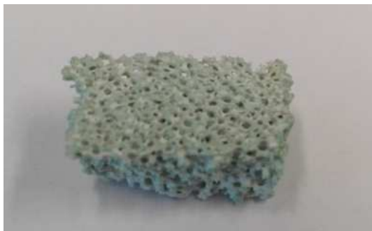
Figura 2: Immagine del supporto di allumina macroporosa impregnata con una soluzione di formiato di Ni e formiato di Co 6:4 (campione ENEA 11)
