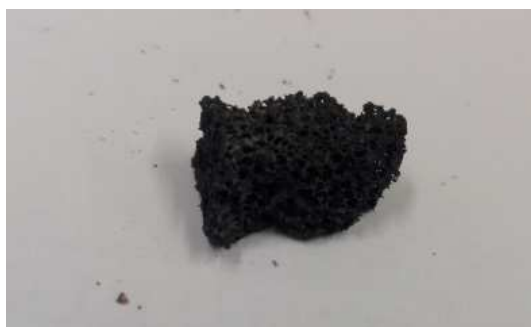
Figura 4: Immagine del supporto di allumina macroporosa impregnata con una soluzione di acetato di Ni e di Co 6:4 (campione ENEA 15) sottoposto a trattamento termico per eliminare il residuo organico
