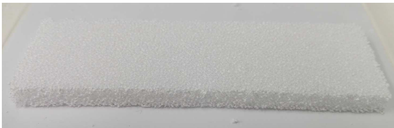
Figura 1: Immagine del supporto a base di schiuma di allumina con porosità del 86 % in volume.
