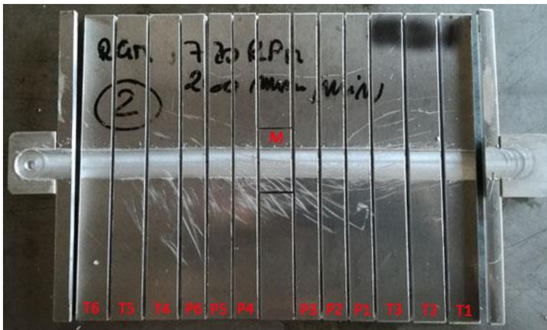
Fig. 6 Taglio dei campioni per prove distruttive
