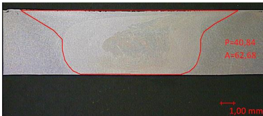
Fig. 10 Campione metallografico con misure del perimetro (P) e dell'area (A) delle zone che hanno subito alterazione termica
