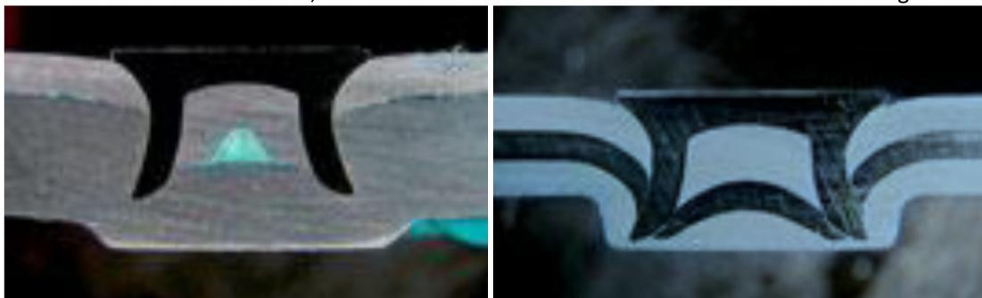
Figura 7– Sezioni di giunzioni rivettate su lamiere di alluminio, realizzate con tecnologia Bollhoff [23].
