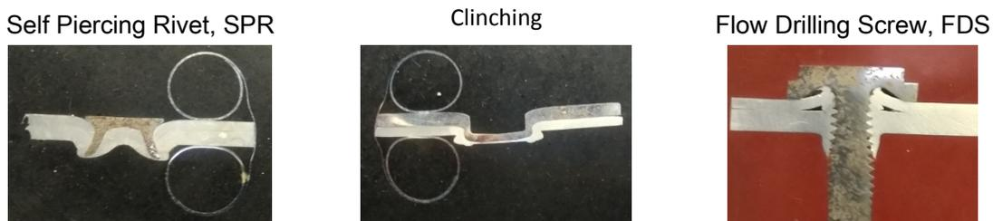
Figura 5– Sistemi di giunzione meccanica.
