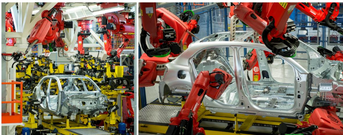
Figura 3– Cella di saldatura simultanea dello stabilimento FCA di MELFI.
