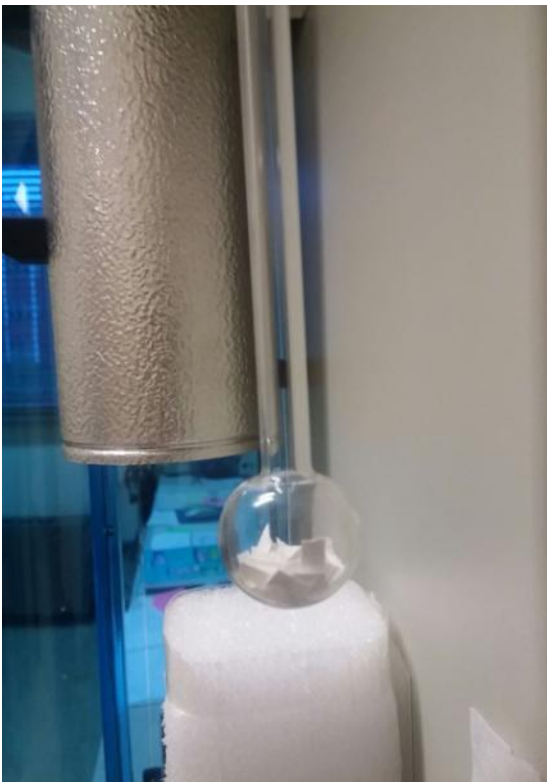
Figura 5. Composito polimero/MOF in forma di film. A) per le misure di adsorbimento di azoto a 77 K, il campione è ridotto in pezzetti di lato circa 3 mm e inserito nel bulbo di una cella in quarzo da 9 mm di diametro. B) Set di campioni di film compositi polimero/MOF preparati su stub per osservazione mediante microscopia elettronica a scansione SEM.
