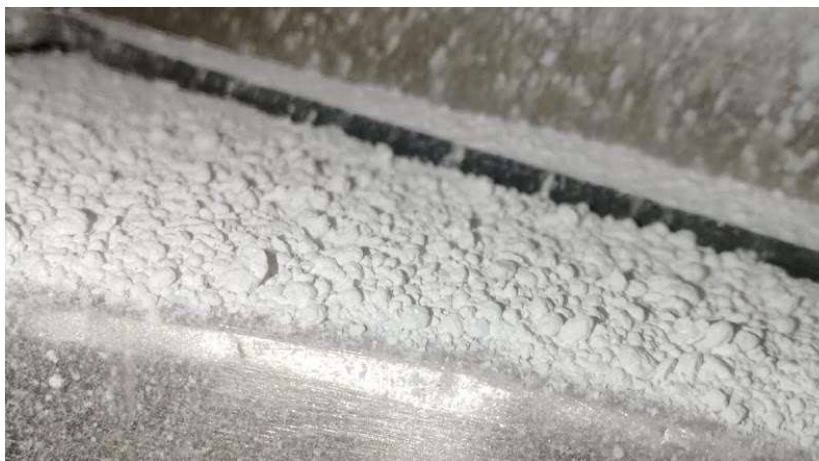
Figura 2.8. Immagine del CAU-10-H (Al) dopo primo trattamento ciclico. È visibile la formazione di agglomerati.
