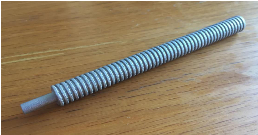
Figura 2.10. Fotografia della sezione di prova realizzata con stampante 3D
