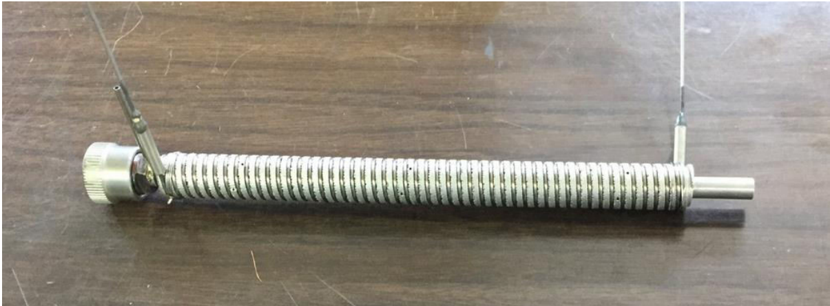
Figura 2.11. Immagine della sezione di prova con il riscaldatore a filo avvolto lungo la filettatura esterna.
