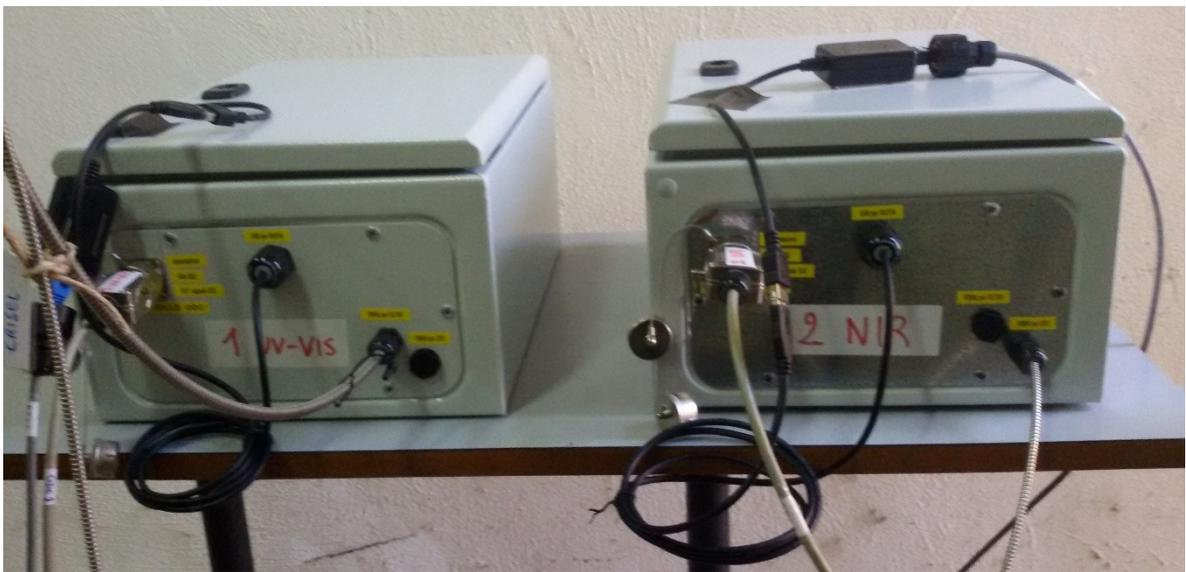
**Figura 4:** Contenitori ATEX all'interno dei quali sono posizionati i sistemi ODC con la ruota porta-filtri per i range UV-VIS e NIR.
