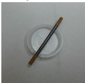
**Figura 2. Membrana tubolare di tipo BSCF**
