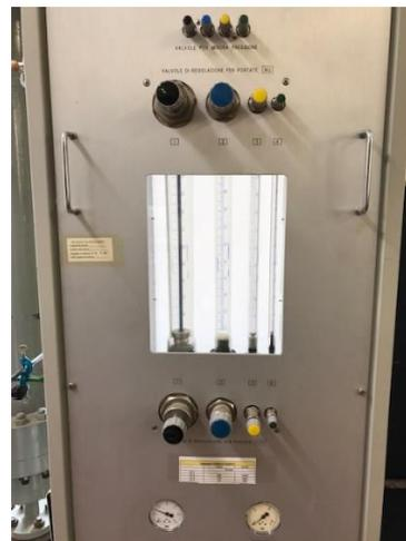
Figura 22. Banco rotametri "Varisco Cariatì" alimentati con aria di rete
