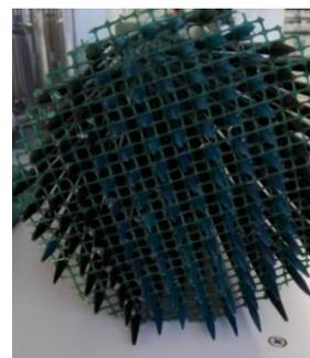
Figura 33. Particolare della maglia quadrata con PITCH = 10 mm
