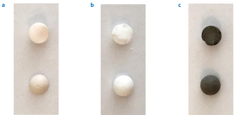
Figura 18: catalizzatore uniforme 0.5wt% Ru/γAl 2 O 3 (da nitrato) da 2300 μm dopo essiccamento a 120°C (a), dopo calcinazione in aria a 400°C (b) o scaricato dopo la marcia riportata in figura 17 (ridotto a 400°C, c)
