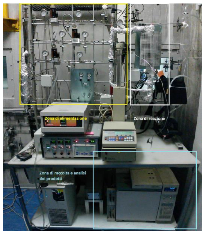
Figura 1: impianto sperimentale "SNG low pressure"
