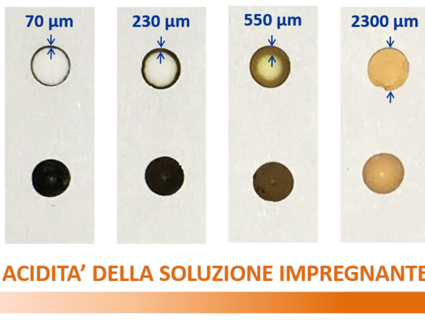
Figura 16: effetto dell'acidità della soluzione impregnante a pari carico metallico sullo spessore dello strato catalitico nel caso di catalizzatori preparati da \text{RuCl}_3 . Carico nominale 0.5wt%; catalizzatori essiccati a 120°C.
