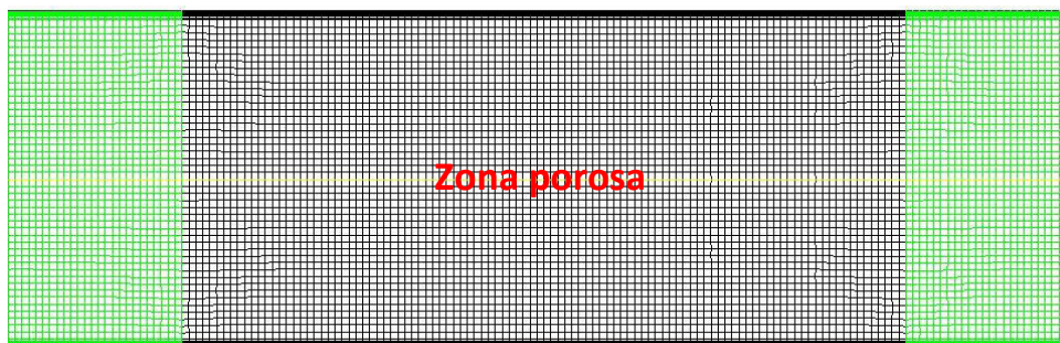
FIG. 8. Modello 2D assial-simmetrico e griglia di calcolo
