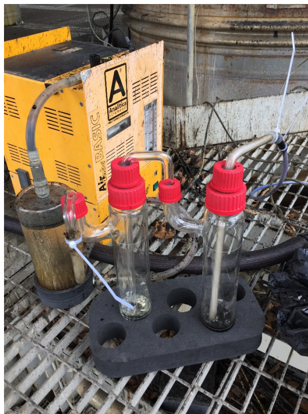
Figura 12. Condensatori (con propanolo) per la cattura del TAR
