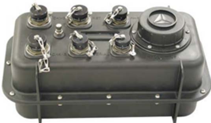
Figura 7. Acquisitore/digitalizzatore 24 bit di tipo Reftek-130_1 (a sinistra) e velocimetro a larga banda di tipo Trillium compact 120 s (a destra). Le immagini dei due oggetti non sono in scala tra loro.
