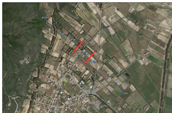
Figura 2. (a) Mappa delle velocità di fase ottenute dall'analisi lungo il profilo lineare. Le linee nere indicano due discontinuità principali nelle caratteristiche dispersive, verosimilmente attribuibili a due faglie lungo le quali è avvenuto il ribassamento della parte orientale del bacino. (b) Profilo delle velocità delle onde di taglio ottenute dall'inversione delle dispersioni mostrate in (a). (c) Proiezione in superficie delle due discontinuità mostrate in (a) e (b)
