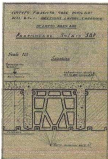
2.5 Disegno esecutivo dell'epoca del solaio SAP.
