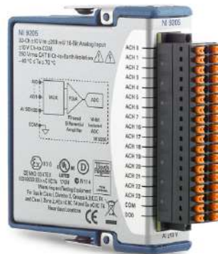
Figura 2.10. National Instrument modulo NI-9205, ingresso tensione
