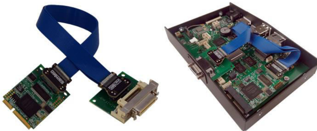
Fig. 27 A sinistra, frame grabber Camera Link. A destra, il frame grabber inserito nel single board computer.
