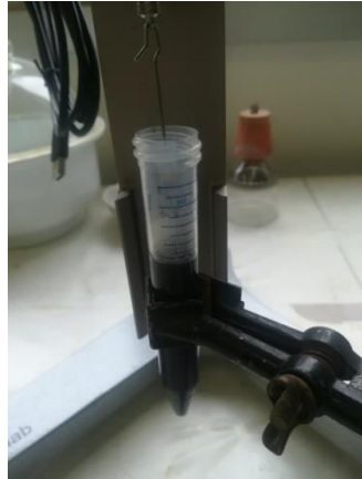
Figura 11 Set-up dell'operazione di rivestimento delle membrane per immersione in una soluzione di GO
