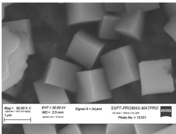
Figura 5 Cristalli cubici di perovskite ottenuti grazie alla presenza di CO2 durante la sintesi in bagno di sali fusi
