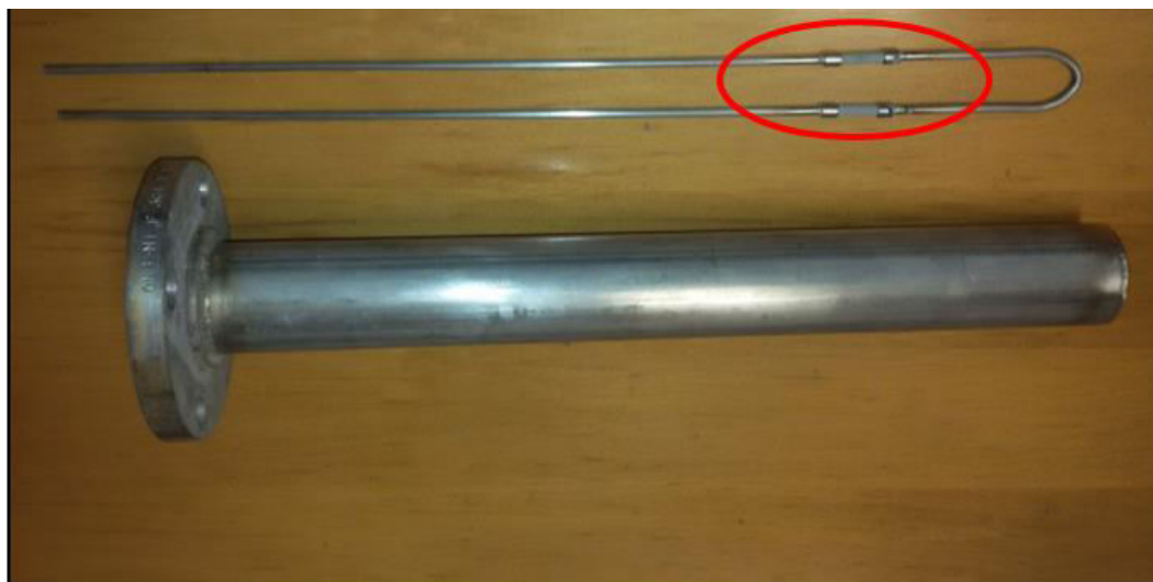
Figura 16 Banco prova realizzato in acciaio per testare le prestazioni delle membrane secondo il disegno riportato in Figura 15
