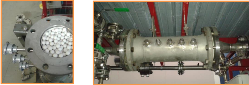
Figura 5: Particolare del reattore di reforming ossidativo del tar
