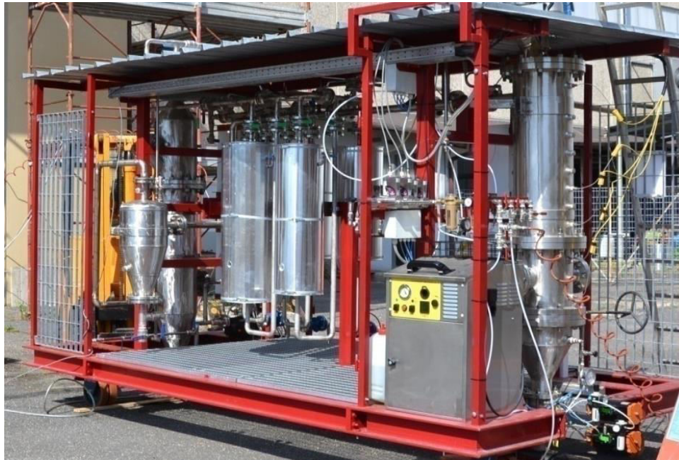
Figura 2: Impianto mobile di produzione di combustibili gassosi
