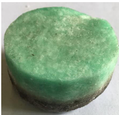
Figura 6. Elemento filtrante con catalizzatore
