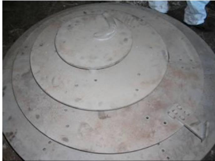
**Figura 3. Parte esterna della griglia del gassificatore dimostrativo**
