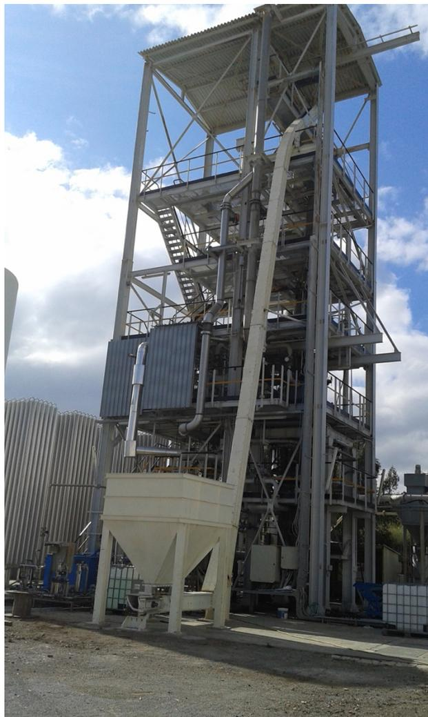
Figura 1. Sistema di caricamento automatico del combustibile "Redler"
