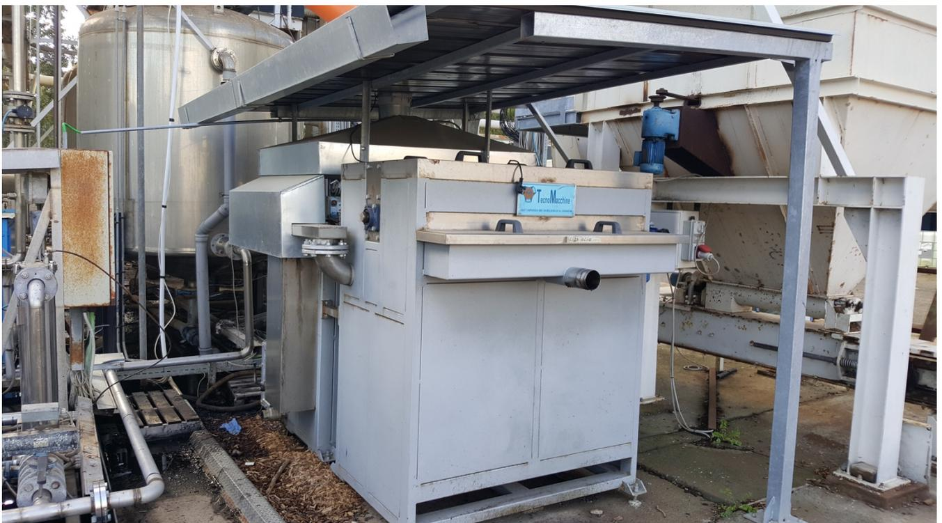
**Figura 14. Disoleatore collegato con il tank del sistema di clean-up**
