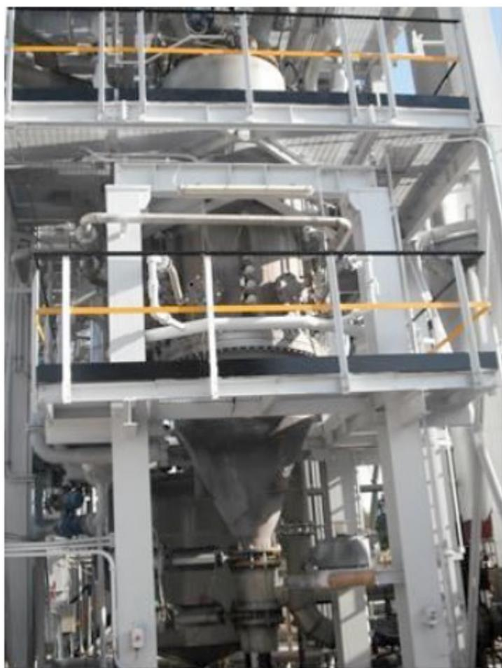
**Figura 2. Gassificatore impianto dimostrativo**
