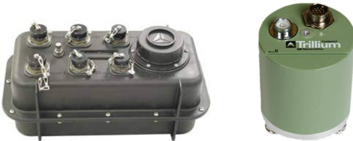
Figura III.2. Acquisitore/digitalizzatore 24 bit di tipo Reftek-130\_1 (a sinistra) e velocimetro a larga banda di tipo Trillium compact 120 s (a destra). I due strumenti costituiscono la stazione SU26 descritta nella Figura III.4. Le immagini dei due oggetti non sono in scala tra loro.
