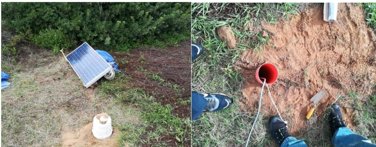
**Figura 3. A sinistra, stazione sismica SUBH; a destra, pozzetto nel quale è installato il sensore.**
