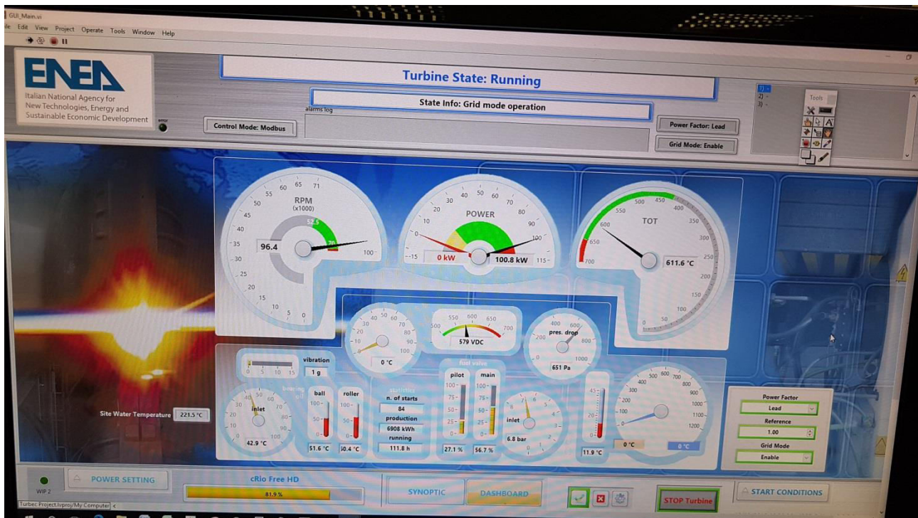
Figura 16. Vista della Dashboard Tab durante uno dei test “a caldo” del sistema di controllo implementato in cRIO.
