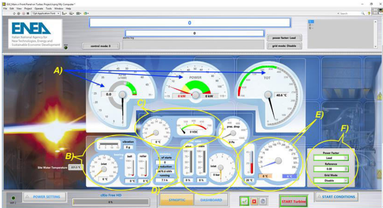
Figura 15. Dashboard Tab. Area A: indicatori principali (RPM, Power e TOT). Area B: indicatori bearings. Area C: indicatori generatore elettrico. Area D: indicatori sistema di alimentazione del combustibile. Area E: indicatori esausti turbina. Area F: Set-points.
