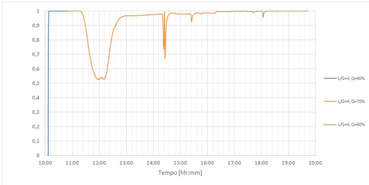
Figura 28. Efficienza di assorbimento della CO2 (Test del 31/10/2018)
