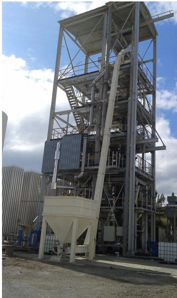
Figura 1. Sistema di caricamento automatico del combustibile "Redler"
