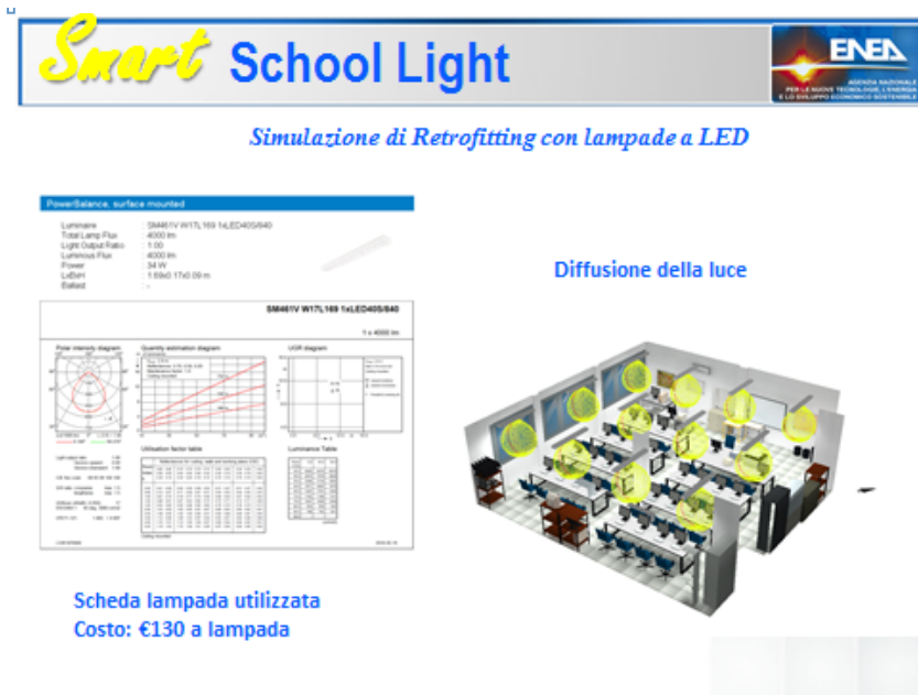
Figura 77. Progetto di retrofitting con lampade a LED analisi della diffusione luminosa
