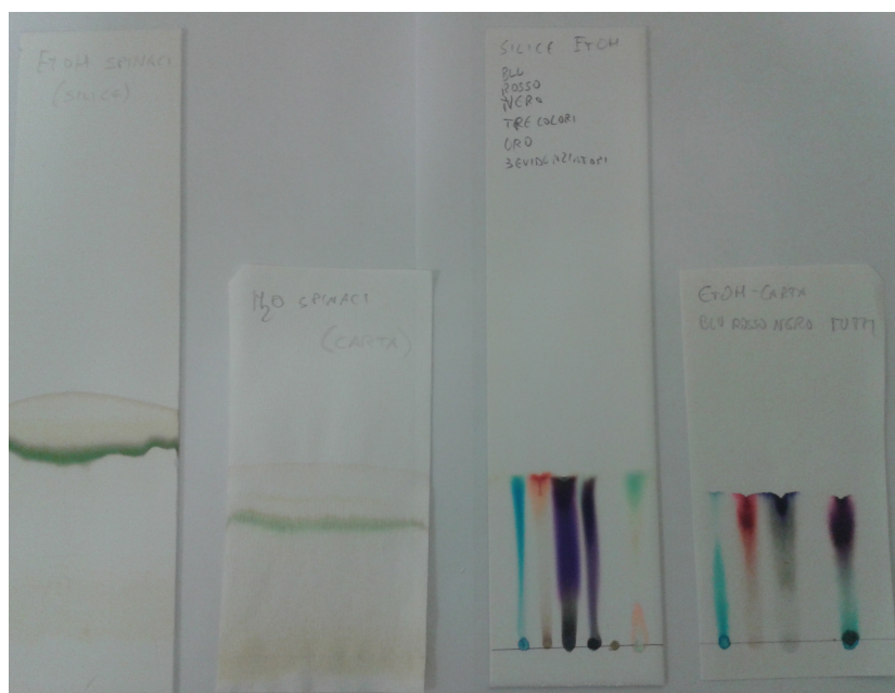
Fig 49. Separazione cromatografica su carta e su gel di silice (con fasi mobili acqua ed etanolo) dei componenti degli spinaci e degli inchiostri di alcuni pennarelli.
