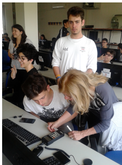
Figura 57. Verifiche di illuminamento con luxmetro in corrispondenza dei punti riferiti ai compiti visivi, in presenza del tutor ENEA
