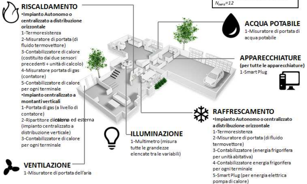
Figura 3 _ Sensori da utilizzare nel Kit "full optional" per gli usi finali dell'energia.
