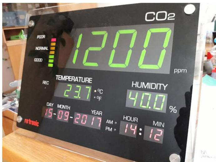
**Figura 74 - Sistema di monitoraggio della CO2 oltre alla Temperatura e dell'umidità.**
