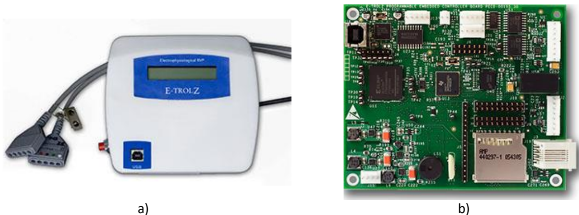
Figura 24. Biomedical Data Acquisition System E-TrolZ [22]: a) esterno e b) particolare dell'hardware del sistema
