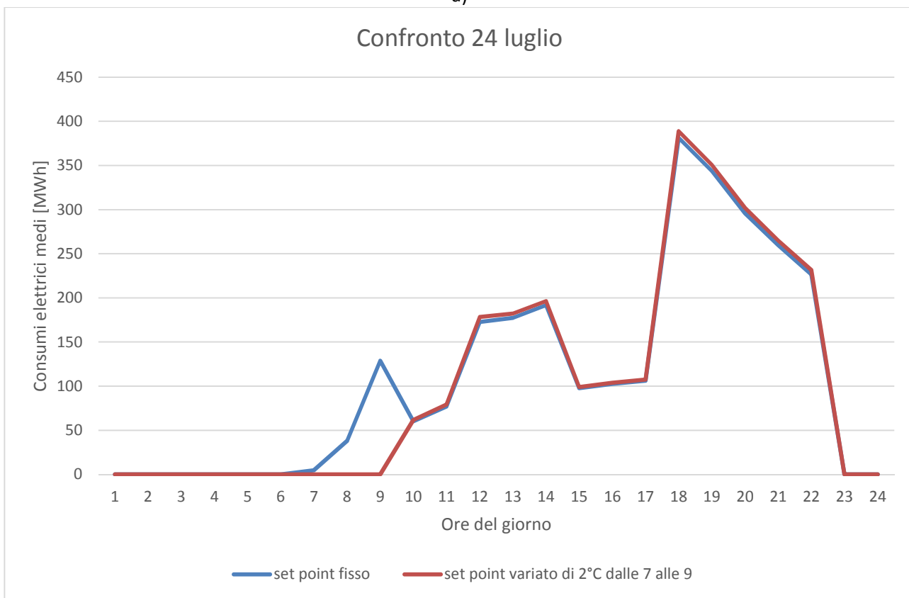
Figura 1 – Esempio di programma di DR con controllo della temperatura dalle 7.00 alle 9.00, Aggregazione di 1000 utenti: (a) profilo di un mese; (b) profilo di un giorno
